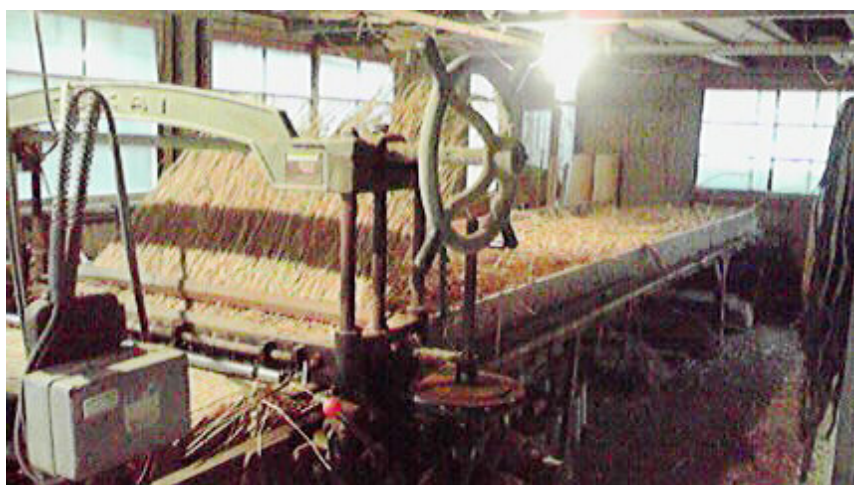
●タタミ床は大きな機械で作られています。
